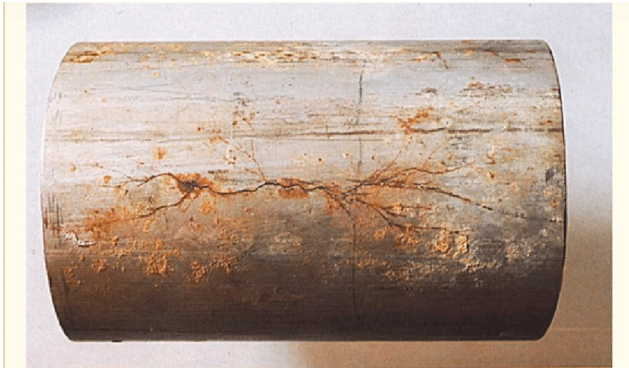
آشنایی با یکی از عوامل مخرب تاسیسات: خوردگی تنشی و روش های کنترل آن
